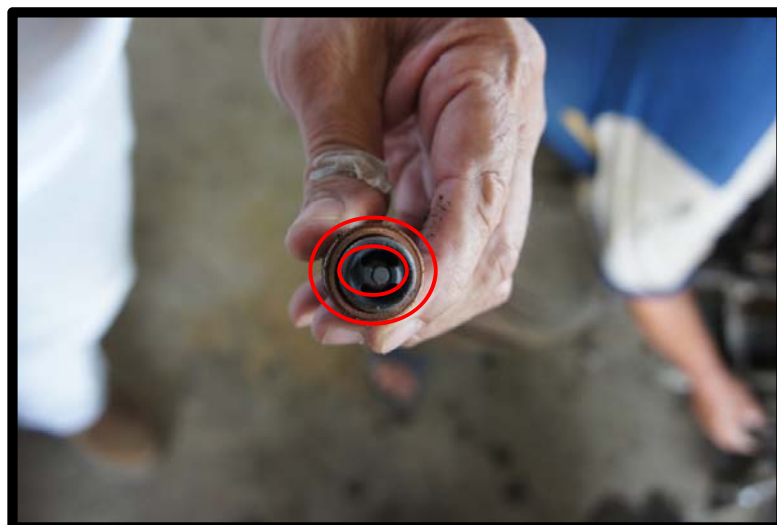
FOTOGRAFIA No. 18 BUJIAS GOLPEADAS
