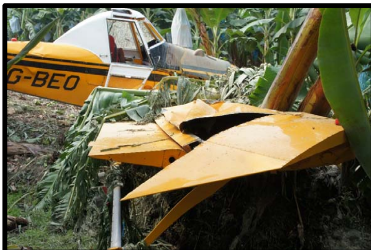
FOTOGRAFIA No. 13 EL ALA DERECHA DAÑADA POR EL GOLPE.
