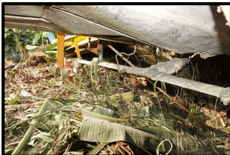
FOTOGRAFIA No. 8 DAÑOS EN LA PARTE INFERIOR DE LA AERONAVE.
