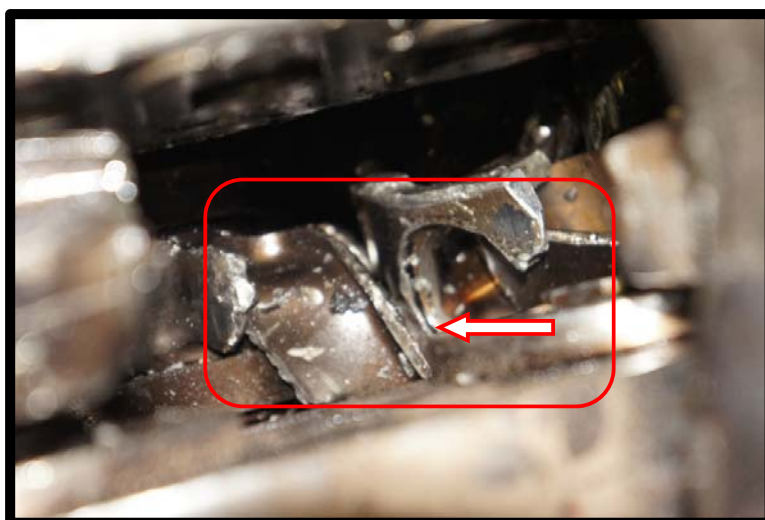
FOTOGRAFIA No. 25 BIELA ACTUADORA DEL CILINDRO PARTIDA
