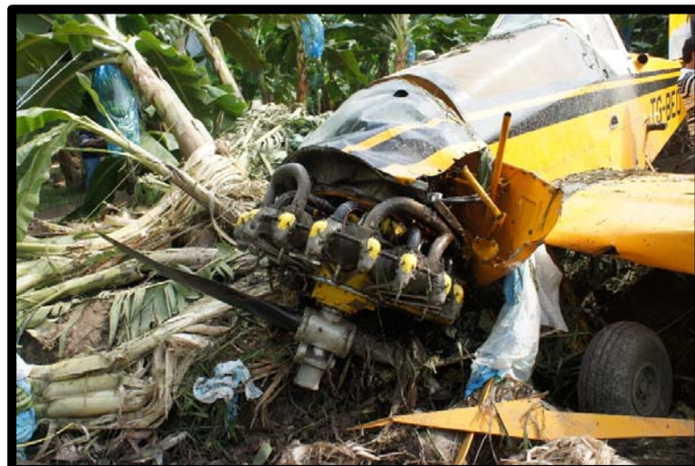
FOTOGRAFIA No. 6 DAÑOS EN LA PARTE FRONTAL DE LA AERONAVE Y MOTOR
