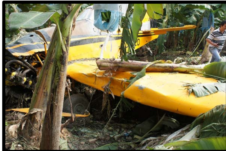
FOTOGRAFIA No. 5 DAÑOS EN EL ALA IZQUIERDA
